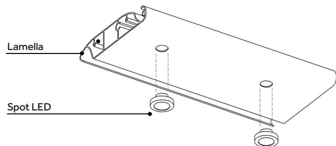
*NB: al momento dell'ordine è possibile specificare se tenere fisse le lamelle con gli Spot LED anche quando il sistema è aperto. Di serie le lamelle sono fisse.*
