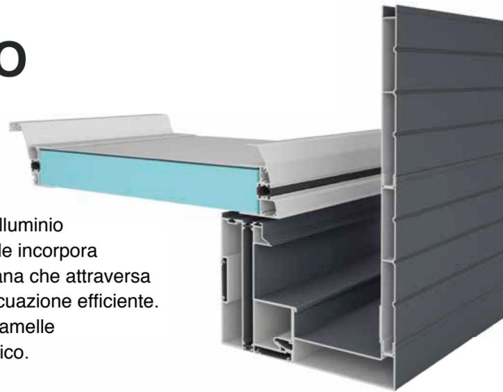
La copertura termica è delimitata da profili in alluminio estruso a taglio termico. La struttura perimetrale incorpora un sistema esclusivo di scolo per l'acqua piovana che attraversa la gronda e si integra nel montante per un'evacuazione efficiente. Le sigillature perimetrali sulla struttura e sulle lamelle migliorano la tenuta all'aria e l'isolamento termico.
