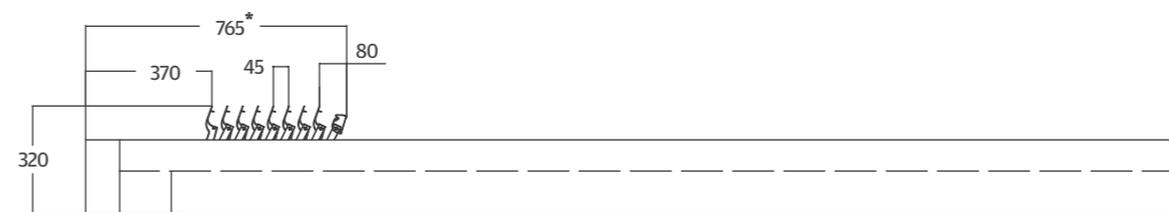
\* Gli ingombri sono calcolati con 8 lamelle. Per ogni lamella aggiunta, dovranno essere aggiunti 45mm all'ingombro sopra citato.
